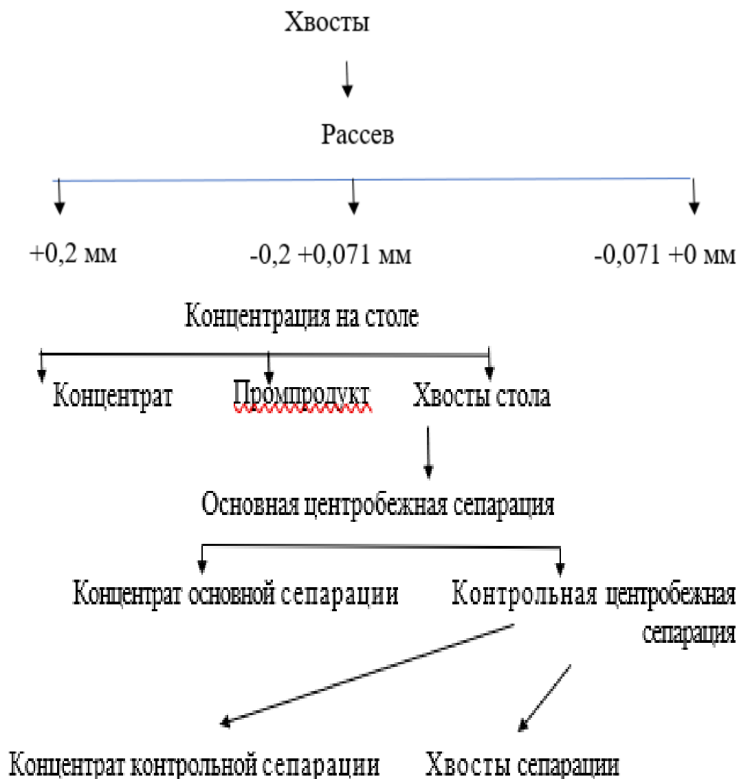
Рисунок 4 – Технологическая схема обогащения гравитационными методом
