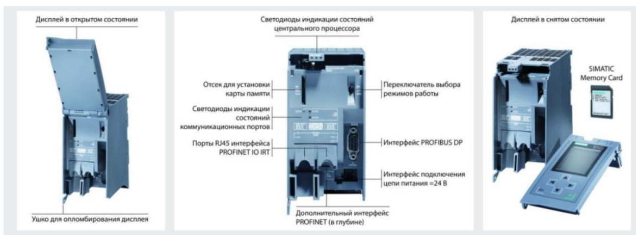
Рисунок 8 – Конструкция контроллера
